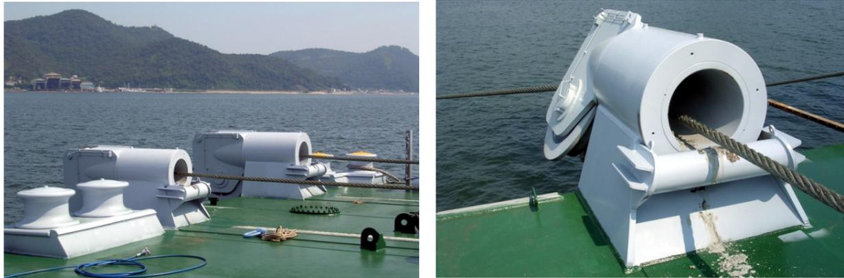
当社では、作業船に搭載される艀装品として 操船・係留などのロープガイド装置に用いられるアンカーフェアリーダ、水平ローラー付フェアリーダなど、用途・仕様に応じた製品を製作しております。写真は起重機船に搭載された特殊型アンカーフェアリーダです。
